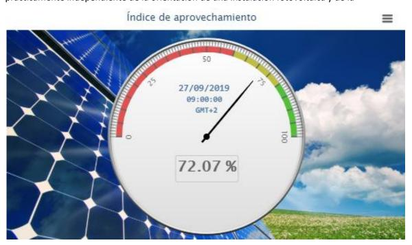
irradiación solar que incide sobre ella. Por este motivo, con ayuda del coeficiente de rendimiento, es posible comparar instalaciones fotovoltaicas conectadas a red en diferentes lugares del mundo.
